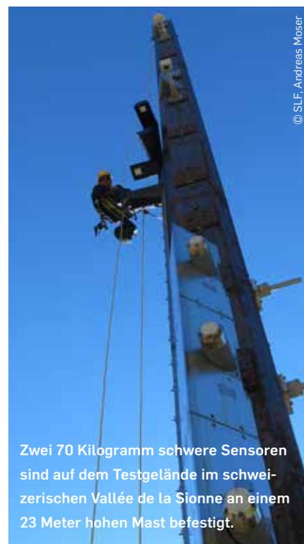
Zwei 70 Kilogramm schwere Sensoren sind auf dem Testgelände im schweizerischen Vallée de la Sionne an einem 23 Meter hohen Mast befestigt.
