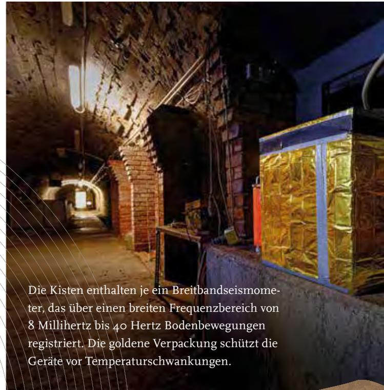
Die Kisten enthalten je ein Breitbandseismometer, das über einen breiten Frequenzbereich von 8 Millihertz bis 40 Hertz Bodenbewegungen registriert. Die goldene Verpackung schützt die Geräte vor Temperaturschwankungen.
