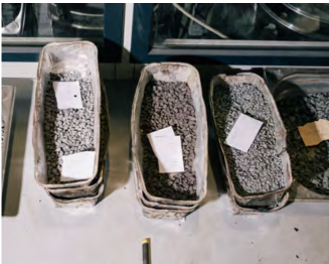
Am Lehrstuhl für Verkehrswegebau lagern unterschiedliche Gesteinskörnungen, die in Deutschland für die Asphaltproduktion verfügbar sind.
