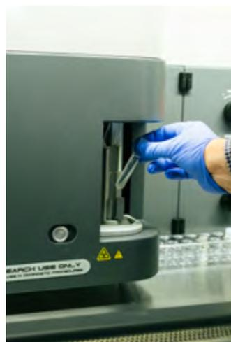
Mit dem Durchflusszytometer lassen sich Immunzell-Subtypen identifizieren, charakterisieren und isolieren. Hierzu werden die einzelnen Zellen eines Gemisches nacheinander mit Licht bestrahlt. Anhand der Streuung des Lichts und der Fluoreszenz können die Wissenschaftler Informationen über die Größe, Struktur und bestimmte Eigenschaften der Zellen gewinnen.
