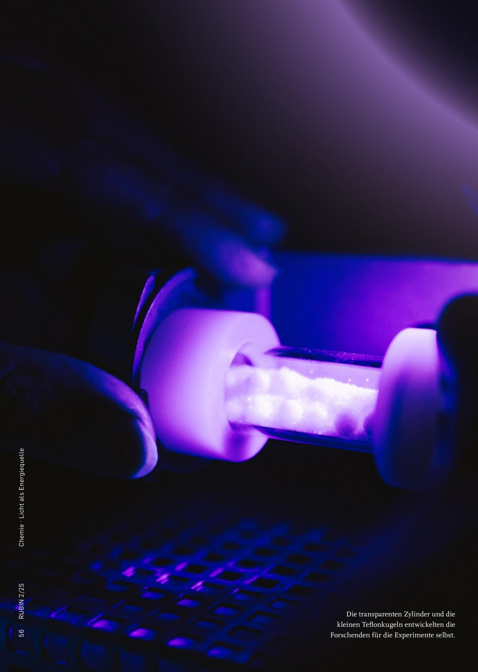
Die transparenten Zylinder und die kleinen Teflonkugeln entwickelten die Forschenden für die Experimente selbst.
