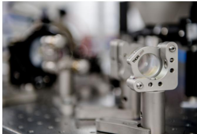
Im Laser wird das Licht von Spiegeln reflektiert und läuft zwischen ihnen hin und her; einer der Spiegel ist teildurchlässig, sodass das Licht als Strahl aus dem Gerät austreten kann. (Foto: RUB, Marquard)
