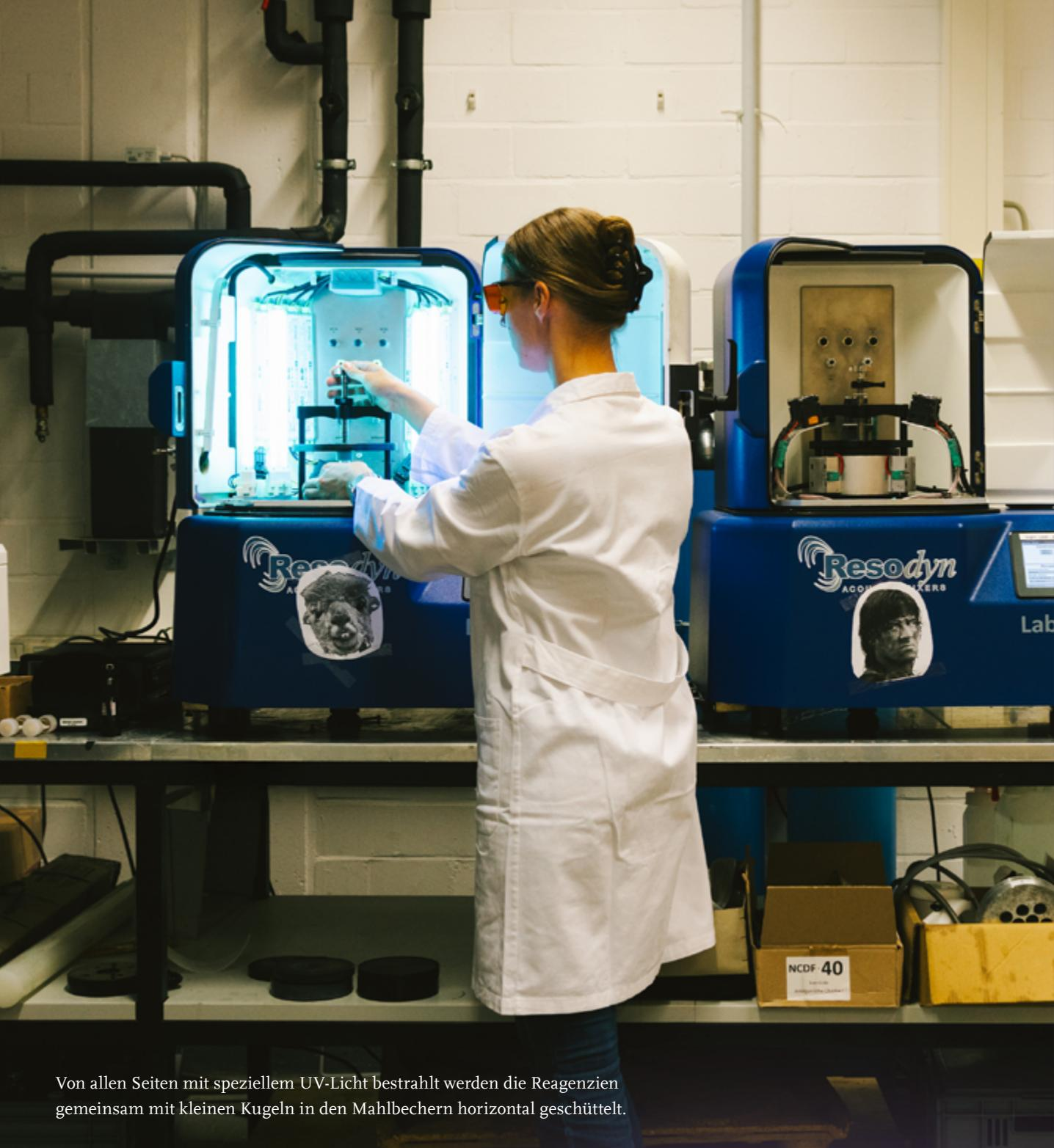
Von allen Seiten mit speziellem UV-Licht bestrahlt werden die Reagenzien gemeinsam mit kleinen Kugeln in den Mahlbechern horizontal geschüttelt.
