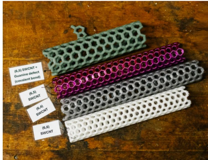
So muss man sich den Aufbau von Kohlenstoff-Nanoröhren vorstellen. Sie bestehen aus einer einzelnen Lage von Kohlenstoff-Atomen, die unterschiedliche Wabenstrukturen bilden können. Anders als diese Modelle aus dem 3D-Drucker sind die echten Röhrrchen 100.000-mal dünner als ein Haar.
