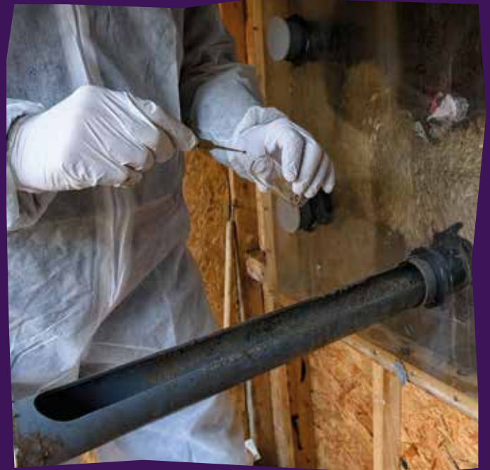
In einem selbst konstruierten Beobachtungsgrab hat Ersin Karapazarlioglu ein Schaf vergraben. Über spezielle Vorrichtungen kann er Proben aus dem Erdreich nehmen.
