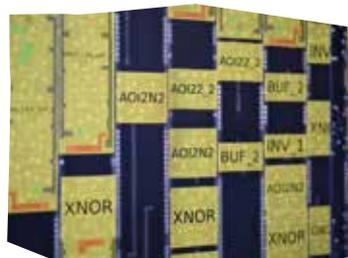
Hier zu sehen sind einige Gatter auf der zweitniedrigsten Schicht eines Chips, die einen Teil der Netzliste ausmachen. Die komplette Netzliste enthält Informationen zu allen Elementen und Verbindungen auf einem Chip.
