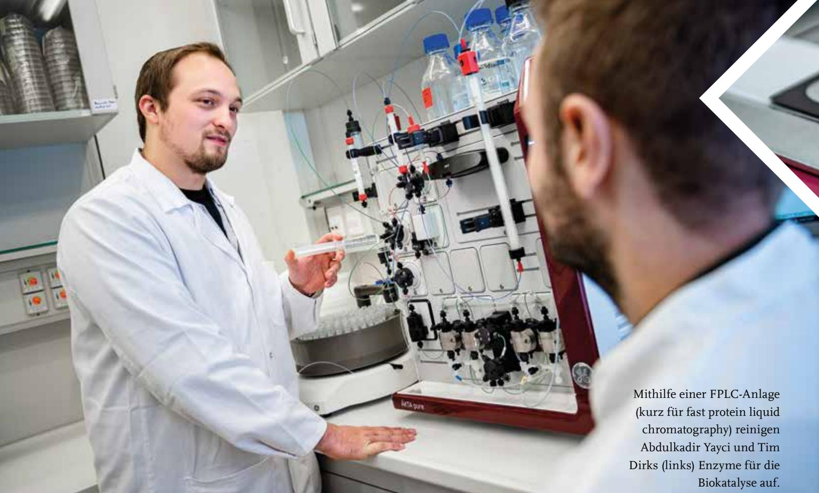
Mithilfe einer FPLC-Anlage (kurz für fast protein liquid chromatography) reinigen Abdulkadir Yayci und Tim Dirks (links) Enzyme für die Biokatalyse auf.
