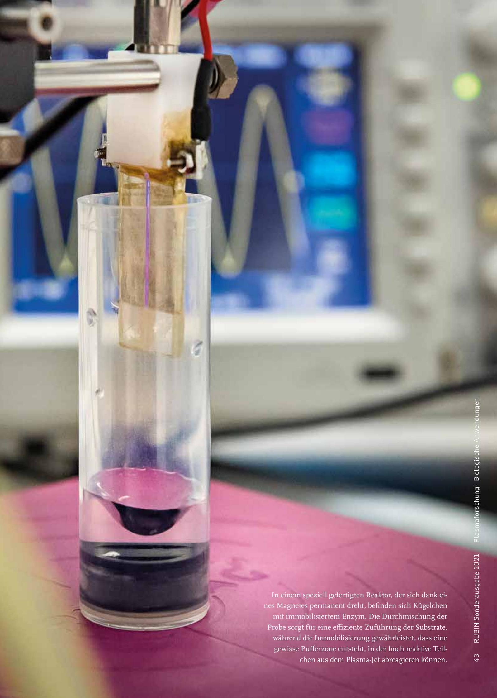
In einem speziell gefertigten Reaktor, der sich dank eines Magnetes permanent dreht, befinden sich Kügelchen mit immobilisiertem Enzym. Die Durchmischung der Probe sorgt für eine effiziente Zuführung der Substrate, während die Immobilisierung gewährleistet, dass eine gewisse Pufferzone entsteht, in der hoch reaktive Teilchen aus dem Plasma-Jet abreagieren können.
