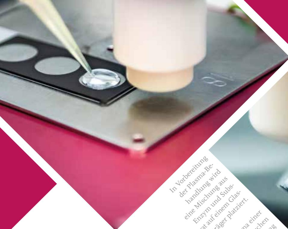
In Vorbereitung der Plasma-Behandlung wird eine Mischung aus Enzym und Substrat auf einem Glas-träger platziert.
