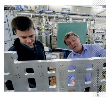
Das Bochumer Team, hier im Bild Malte Albrecht (links) und UIrich Wiedner, baut ein Kalorimeter, das Photonen, also Lichtteilchen, nachweisen kann. Dazu wird der Korpus des Kalorimeters mit speziellen Kristallen aus Bleiwolframat bestückt.
