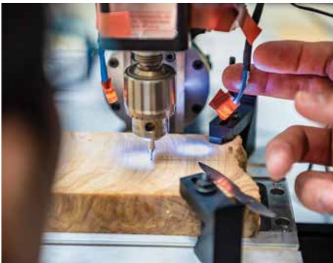
Mit einer computergesteuerten Fräse entnehmen die Forscher Proben aus dem Tropfstein. (Foto: dg)
