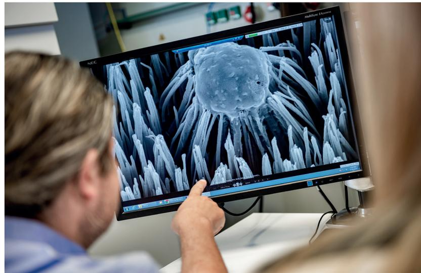
Mittels Rasterelektronenmikroskopie kann die Interaktion zwischen biologischen Objekten wie Zellen und Bakterien mit den nanostrukturierten Oberflächen untersucht werden.
