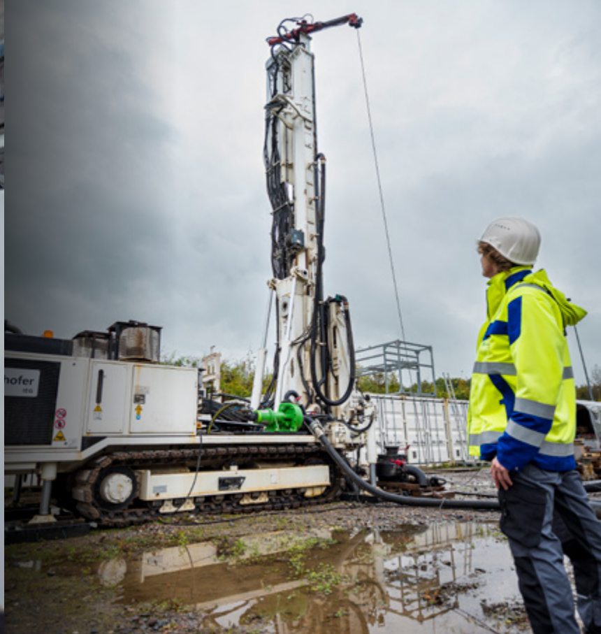
Das Bohrgerät BO.REX (Bochum Research and Exploration Drilling Rig) ist eine mobile 40-Tonnen-Bohranlage, mit der bisher zu Forschungszwecken rund 10.000 Bohrmeter bis in Teufen von 500 Meter abgeteuft wurden. Sie wurde für die Erschließung des Grubengebäudes genutzt. (Foto: dg)
