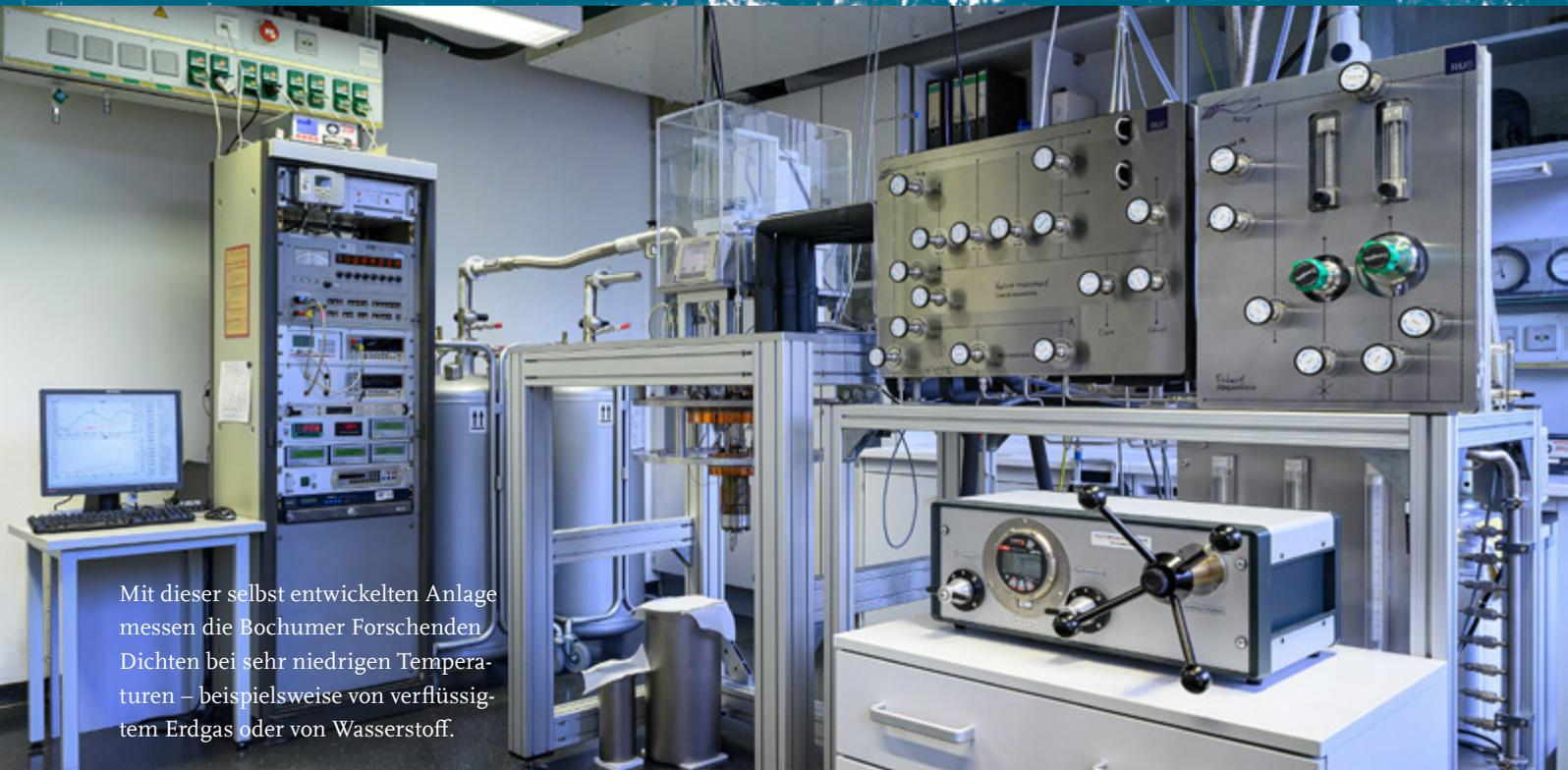
Mit dieser selbst entwickelten Anlage messen die Bochumer Forschenden Dichten bei sehr niedrigen Temperaturen – beispielsweise von verflüssigtem Erdgas oder von Wasserstoff.
