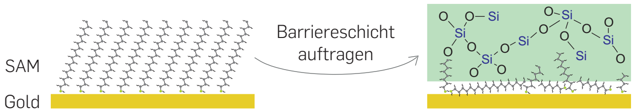
Abb. 2: Der sauerstoffhaltige Plasmaprozess zur Abscheidung der Barrierschicht aus Siliziumdioxid (grün) greift die Kunststoffoberfläche an. Das zeigte das RUB-Team anhand einer selbstorganisierenden Monoschicht (SAM), die durch die Abscheidung ihre Ordnung verliert.
